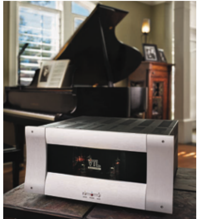
200 watt per canale, commutabile a triodi con 2X100W per S-200 il finale dotato di 8XKT88 della serie Signature con fattore di smorzamento regolabile su 3 valori.
