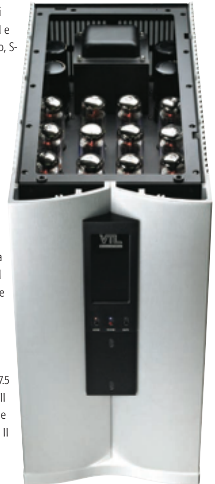
Siegfried Serie II è probabilmente il più potente finale monofonico a valvole in commercio. 12XKT88 e 650/330W di potenza secondo se l'uso è pentodo o triodo, al top della gamma Reference.
