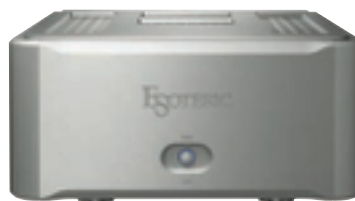
S-03 Finale di potenza stereo 2X145W su 8 ohm Triplo darlington 5 push-pull paralleli, 25A di picco Chassis in acciaio, ingressi XLR/RCA
