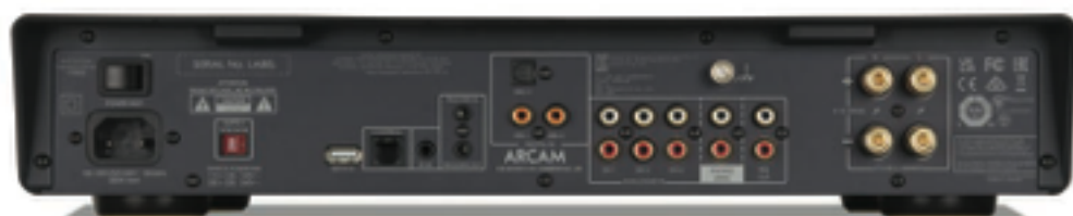
Oltre a numerosi ingressi analogici, A5, come A15 sono dotati di DAC e quindi di 2 ingressi coassiali e uno ottico. I binding post per i diffusori sono di ottima fattura e possono accettare sia banana che cavo spellato, ma è consigliabile adottare la prima soluzione, non essendoci molto spazio a disposizione.
