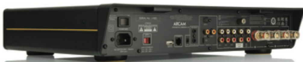
Tutti i prodotti Radia sono caratterizzati da un coperchio di forma che nasconde alla vista i cavi. In foto il pannello posteriore dell'A25, dotato di DAC incorporato, e quindi di numerosi ingressi digitali oltre che analogici.
