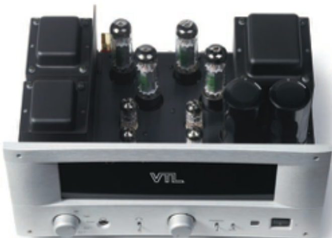
Unico integrato prodotto da VTL questo IT-85, 2X60W con 4XEL34, telecomando, e uscita cuffia sul pannello frontale con amplificatore dedicato.
