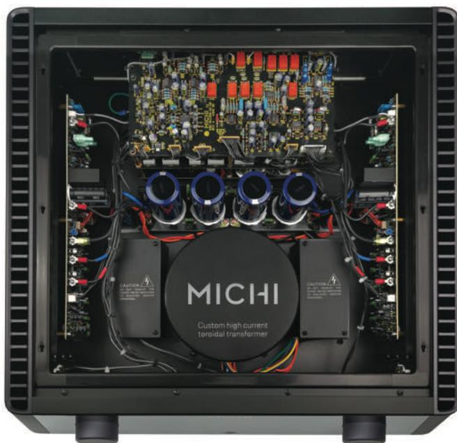
*Singolo trasformatore e configurazione dual-mono a partire dai condensatori di filtro. Notare il surdimensionamento degli stadi finali, assicurati su grandi alette di raffreddamento solidali al mobile*
