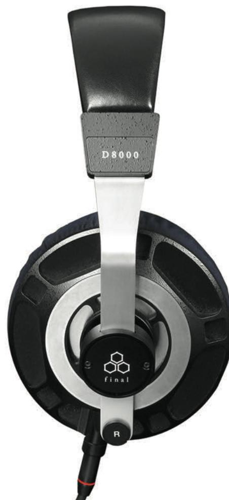
*La D8000 e D8000 Pro hanno parametri elettrici che favoriscono il pilotaggio da qualsiasi sorgente, visti i 98 dB di efficienza con una impedenza di 60 ohm. Ovviamente vista la qualità del prodotto, è consigliato un amplificatore di alto livello.*
