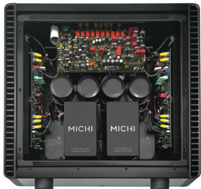
*Due i trasformatori toroidali, attinti dal finale S5, e 4 grossi condensatori di filtro. Il dispiegamento di forze è impressionante, la configurazione è completamente dual-mono e i transistor di potenza sono ben 8 a canale.*
