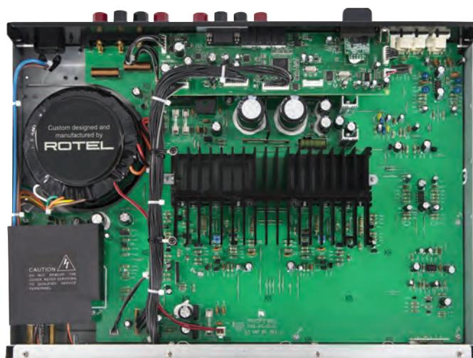
*Molto razionale l'interno di A-11. Un grosso trasformatore toroidale e una generosa elettatura per dissipare la potenza generata dai transistor finali. Notare la cura nel layout, davvero razionale e ben organizzato.*
