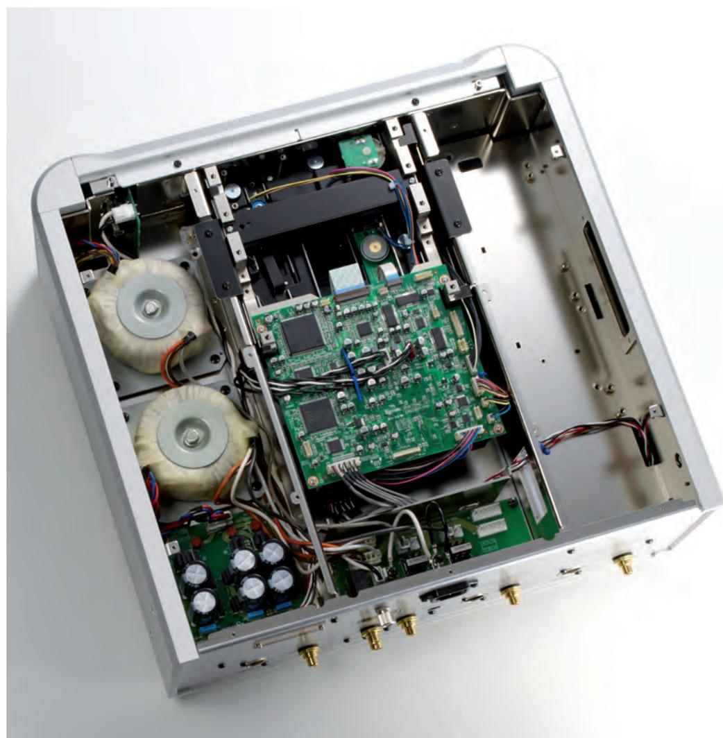
*Separate le alimentazioni per digitale e analogico, con sezioni di filtraggio dedicate per ogni stadio. Notare la costruzione a scomparti, che isola sia meccanicamente che dai disturbi ogni sezione funzionale.*
