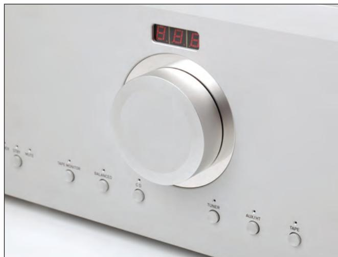
*Il pannello frontale è in alluminio massiccio ed è solo uno dei testimoni della costruzione di M6 500i. Notare il display del volume, realizzato con 3 semplici display rossi e la grossa manopola del volume in alluminio tornito dal pieno.*
