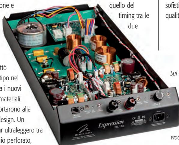
*Sul fondo del diffusore è alloggiato il cabinet che contiene due finali da 300W, uno per ogni woofer, e il complesso crossover necessario per il taglio tra woofer e pannello*
