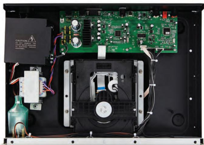
*La meccanica in dotazione a CD-11 è molto buona e nettamente superiore rispetto a quelle montate nei lettori di questo livello di prezzo. A ridosso del pannello posteriore è sistemata la scheda di alimentazione conversione DA*
