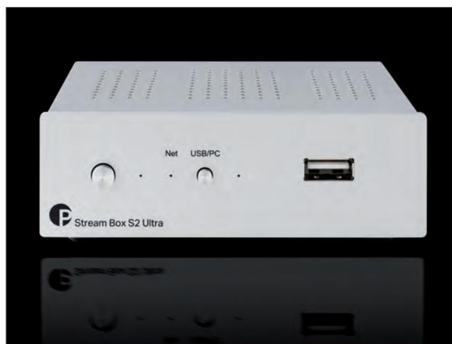
*Notare le dimensioni estremamente compatte dello steamer. Sul pannello frontale solo il tasto di accensione, quello per la selezione ingresso e una delle USB A che può accettare qualsiasi unità di memoria esterna.*
