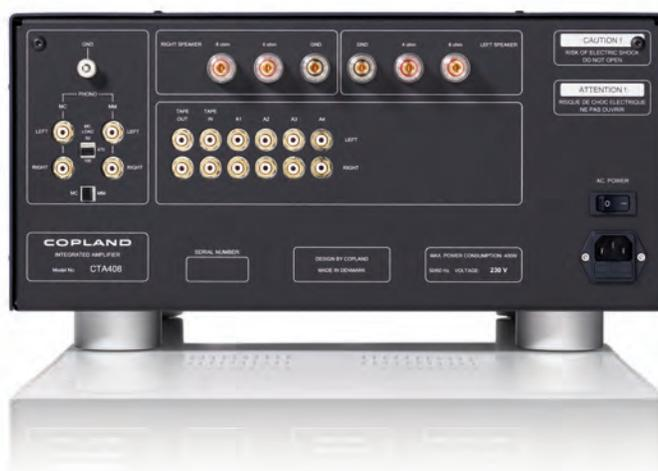
4 gli ingressi linea, 1 phono MM/MC con impedenza selezionabile e un tape loop. Di alta qualità i binding-post di uscita per i diffusori con presa sia a 4ohm che a 8 ohm.
