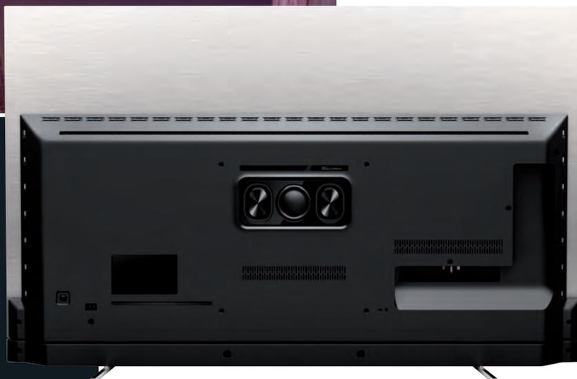
*Notare i due subwoofer rettangolari in alluminio con il passivo centrale ai quali è affidata la riproduzione delle basse frequenze. Sono in grado di riprodurre con grande fedeltà il registro grave, al pari di una sound-bar di ottima qualità.*
