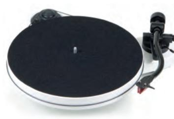
**RPM 1 Carbon** Giradischi compreso di braccio, trazione a cinghia, velocità 33/45 giri. Piatto in MDF a bassa risonanza e matte in feltro. Braccio in resina di alluminio/carbonio a S da 8,6" con antiskating magnetico. Motore in DC esterno disaccoppiato dal telaio. Disponibile nei colori nero laccato, rosso laccato o bianco laccato.
