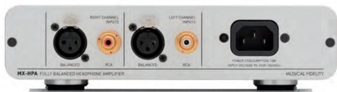
*Ingressi sia bilanciati che sbilanciati per MX-HPA con connettori di alto livello e placcati oro. L'alimentatore è interno, e quindi è presente la classica vaschetta IEC per il cordone di alimentazione. Notare il contenitore completamente in alluminio, a garanzia della massima reiezione dai disturbi.*
