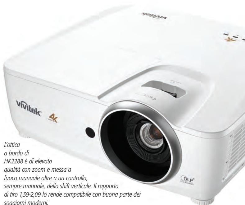
*L'ottica a bordo di HK2288 è di elevata qualità con zoom e messa a fuoco manuale oltre a un controllo, sempre manuale, dello shift verticale. Il rapporto di tiro 1,39-2,09 lo rende compatibile con buona parte dei soggiorni moderni.*
