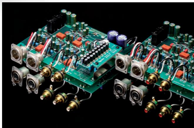
I connettori utilizzati sono di tipo professionale e garantiscono una elevata qualità del contatto anche dopo molti anni. Ogni particolare è curato in modo maniacale, addirittura i cavi di interconnessione utilizzati per gli spinotti sono in rame OFC ad alta sezione.
