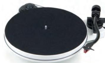
**RPM 1 Carbon** Giradischi compreso di braccio, trazione a cinghia, velocità 33/45 giri. Piatto in MDF a bassa risonanza e matte in feltro. Braccio in resina di alluminio/carbonio a S da 8,6" con antiskating magnetico. Motore in DC esterno disaccoppiato dal telaio. Disponibile nei colori nero laccato, rosso laccato o bianco laccato.
