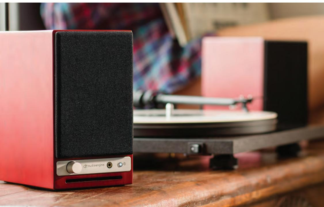
Sul baffle del diffusore è sistemata la bocca di accordo del bass-reflex, di tipo rettangolare. Appena sopra la manopola per la regolazione del volume, l'uscita cuffia e il led di accensione.
