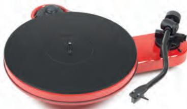
**RPM 3 Carbon** Giradischi compreso di braccio con trazione a cinghia e velocità 33/45 giri. Dotato di piatto in MDF a bassa risonanza e matte in vinile. E' dotato di braccio in resina di alluminio/carbonio a S da 10" e antiskating magnetico. Motore in DC esterno, disaccoppiato dal telaio. Disponibile nei colori nero laccato, rosso laccato o bianco laccato.
