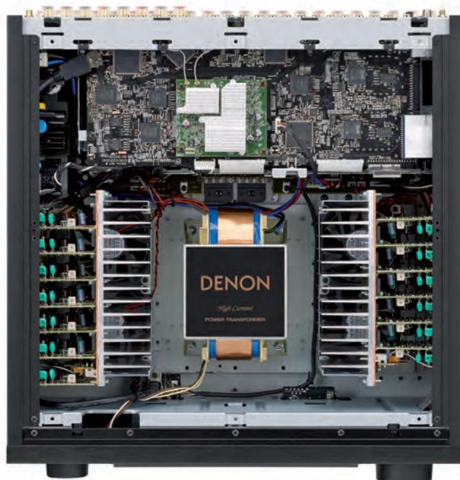
L'ordine è impressionante, con una filatura praticamente assente. Al centro il grosso trasformatore, ai lati le 13 sezioni di potenza e a ridosso del pannello posteriore l'elettronica di elaborazione audio/video. Notare la grande complessità della scheda video che ospita anche (al centro) il modulo HEOS.
