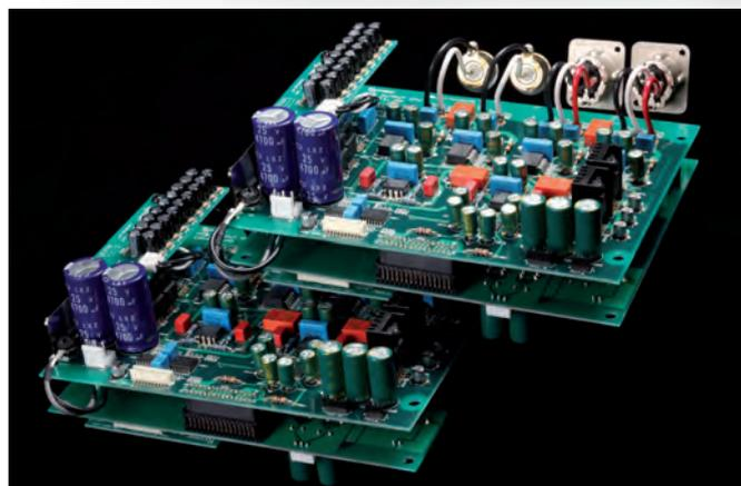
Le schede di ingresso e uscita sono completamente separate per i due canali, e ospitano, oltre ai circuiti di preamplificazione, anche quelli di alimentazione e filtraggio, divisi per sezioni e in più rami, in modo da non creare alcuna interferenza energetica tra i circuiti.
