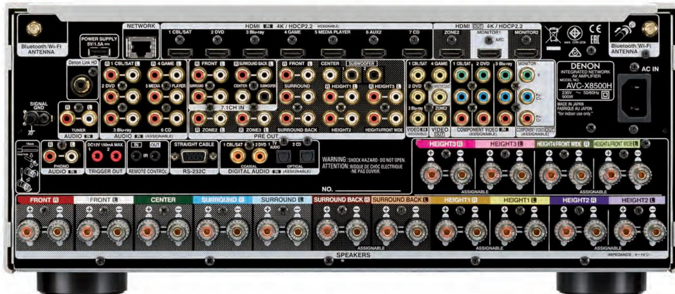
Il parco connessioni di AVC-X8500H è impressionante. Oltre alle uscite per i diffusori, addirittura sistemate su due file, sono presenti le uscite pre-out 15.2, oltre agli 8 HDMI IN/3 out.
